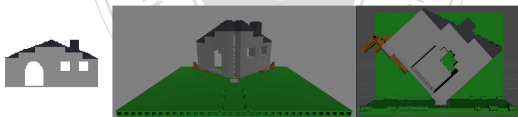
圖 38 呈現簡單房屋的 V 型結構。左圖為輸入影像(參考圖 1)，中間圖為生成之設計，右圖為將立體書闔上後的結構圖(切除左書頁)。
