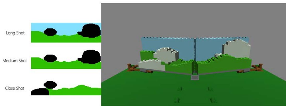
圖 37 呈現山、雲與天空的風景之 V 型結構。左邊三張圖為輸入的影像，從下到上分別為近景、中景與遠景。右圖為輸出的結果，我們將輸入影像中白色的雲轉為黑色以方便觀察。
