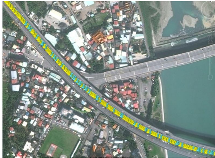
圖5.5. 高速移動下 BD 970 之 VBS-RTK GPS 與後處理動態差分定位成果套疊
