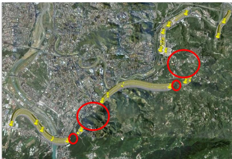
圖5.4. 快速移動下 GPS 接收模組 BD970 之 VBS-RTK GPS 定位軌跡
