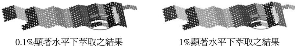
圖十五 以資料蒐評法進行屋頂面萃取時分別使用不同顯著水平下所得之結果透視圖
