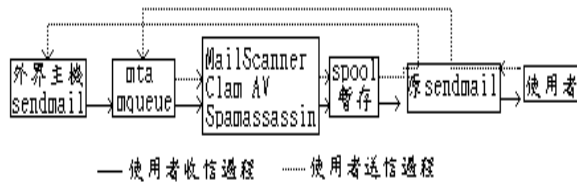
圖 2 MailScanner 系統郵件處理過程示意圖
