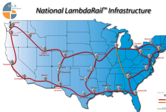
圖 7 National LambdaRail 光網路架構。取自 NLR Topology 網頁[8]
