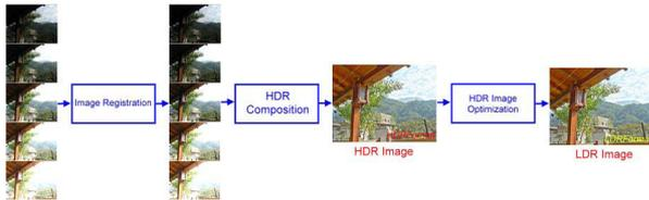
圖 3 高動態範圍影像系統流程圖。
