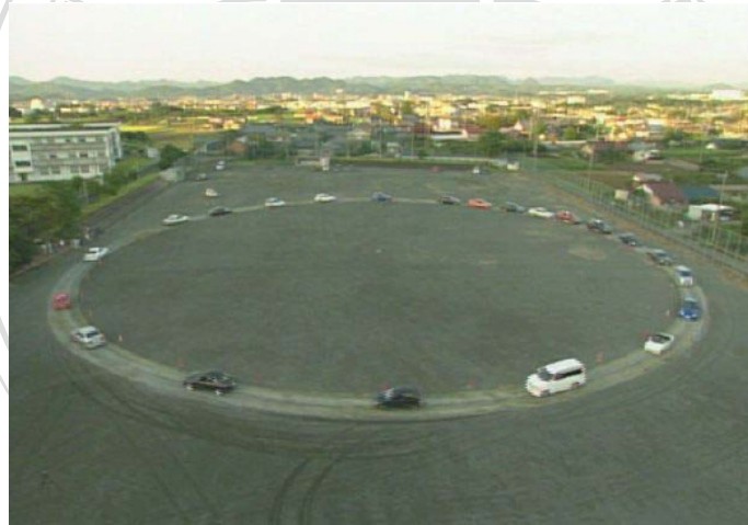
圖 2.6：控制實驗快照圖，源自文獻 [30]。環型車道圓周為 230 公尺，車輛數為 22。車道上無瓶頸及其他障礙，環型車道設計主要避免車道進出口帶來的邊界效應，為一具平移不變（translation invariance）的系統。
