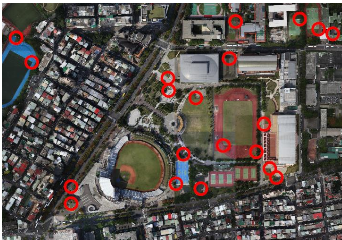
(a) 正射影像精度檢核點位分布
