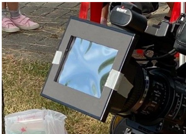
圖 4-6：巴德膜利用厚紙板加工後，呈現鏡框狀態貼於攝影機鏡頭前，並使用膠帶固定。
