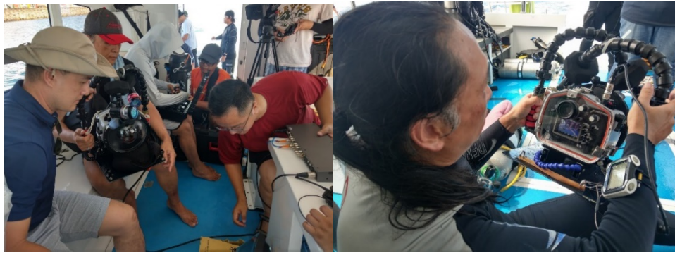
圖 4-3：水下攝影師與團隊嘗試將水下攝影機連接到導播控盤，確認訊號狀態。
