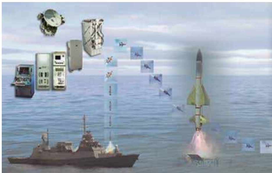
附圖 B-4：閃電飛彈系統組成及反飛彈彈道示意圖
