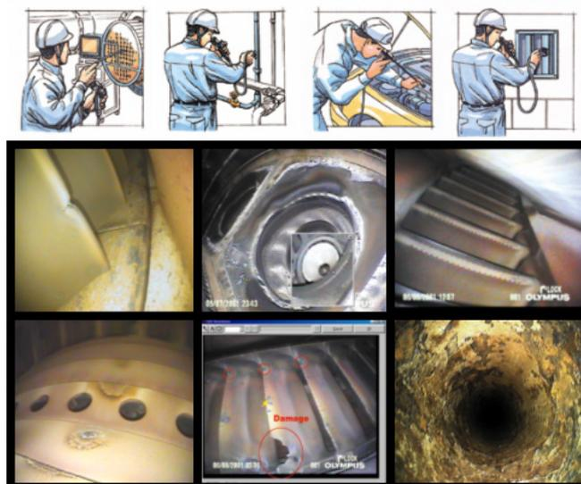
圖 4-3：非破壞性檢測的使用與結果
