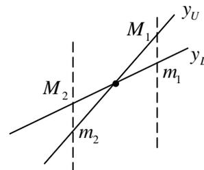
圖 2.3 在模糊迴歸點的左側，預測值  $y=[m_2, M_2]$  的上界落在  $y_L$  上，下界落在  $y_U$  上
