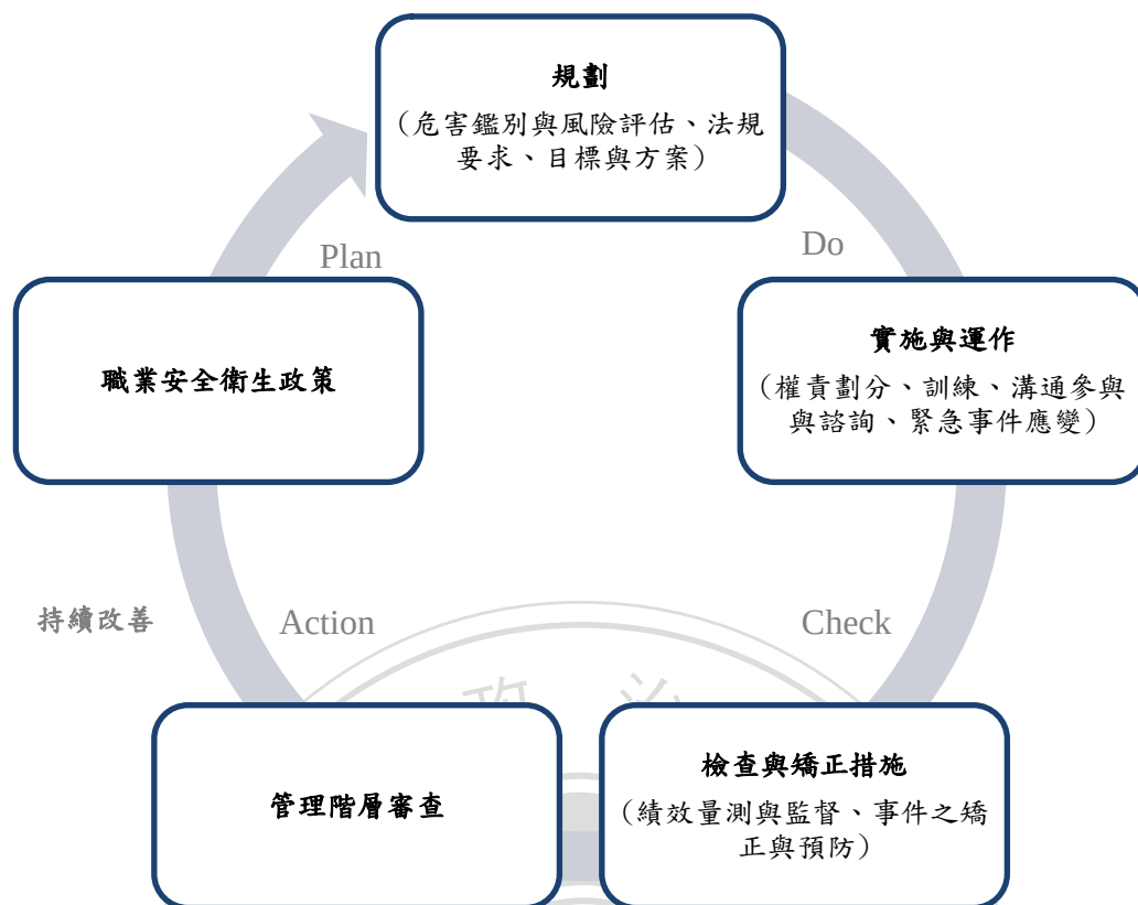
圖 2-3 OHSAS 18001 之 P-D-C-A 之循環架構
