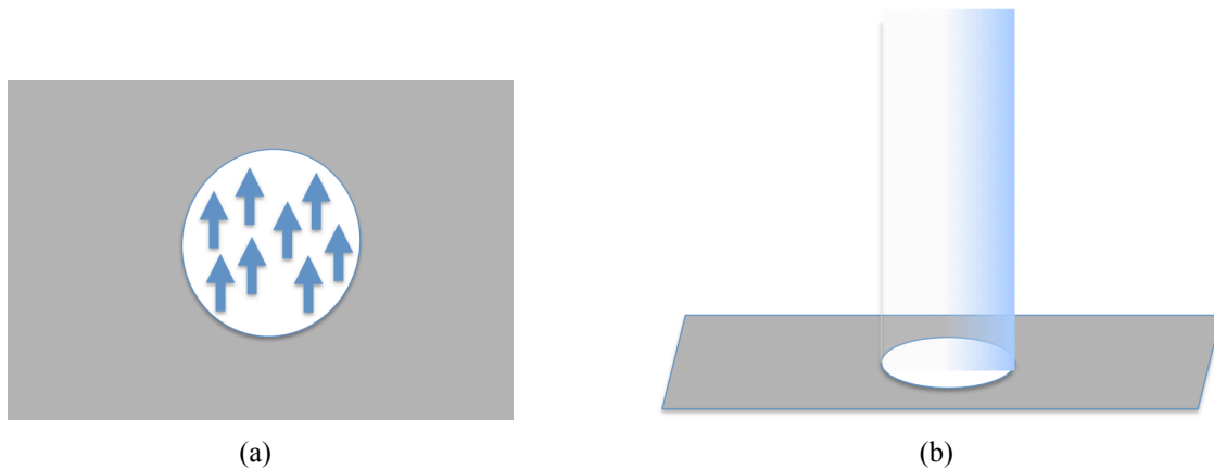
圖 2.2: 無序鐵磁性物質順磁相 Griffiths 奇點現象機制之示意圖。在無序的順磁相內因非均質性仍存在一局部呈鐵磁相的區塊，這些區塊發生機率不高，但可造成如磁化率等物理量在臨界點外區間亦產生奇點。(a) 白色區域示意在二維古典系統中順磁相內局部鐵磁相的區塊；(b) 在二維量子系統中，空間上的局部鐵磁相的區塊延伸至虛數時間方向，故可造成比在古典系統更明顯的 Griffiths 奇點現象。
