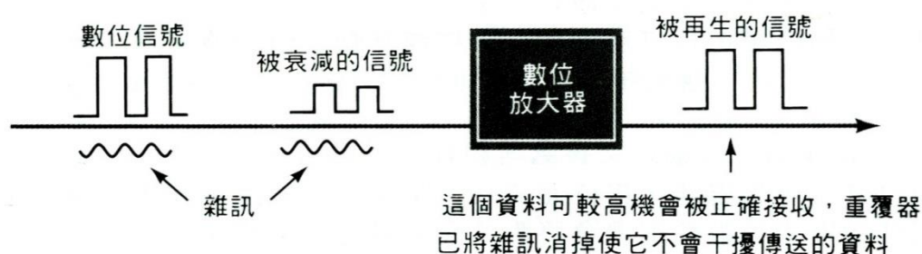
圖 2-11. 數位訊號經過放大器後，雜訊也同時消除
