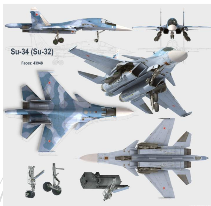
圖 2-16 NAPO 的 Su-34，由此圖可見外觀已與 Su-27 差異甚多，對地攻擊性能出眾。
