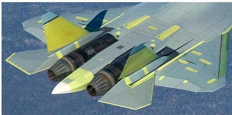
圖 3-5 T-50 的可動引擎噴嘴，估計不具備匿蹤能力。
